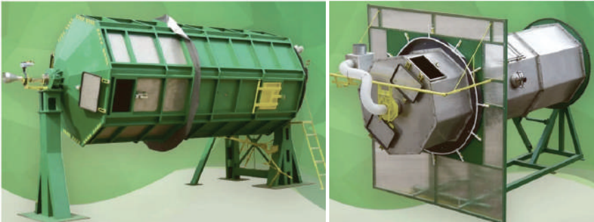
Рис. 3.12. Субстратні машини СМ-8 та СМ1-РС виробництва компанії «Технік»
